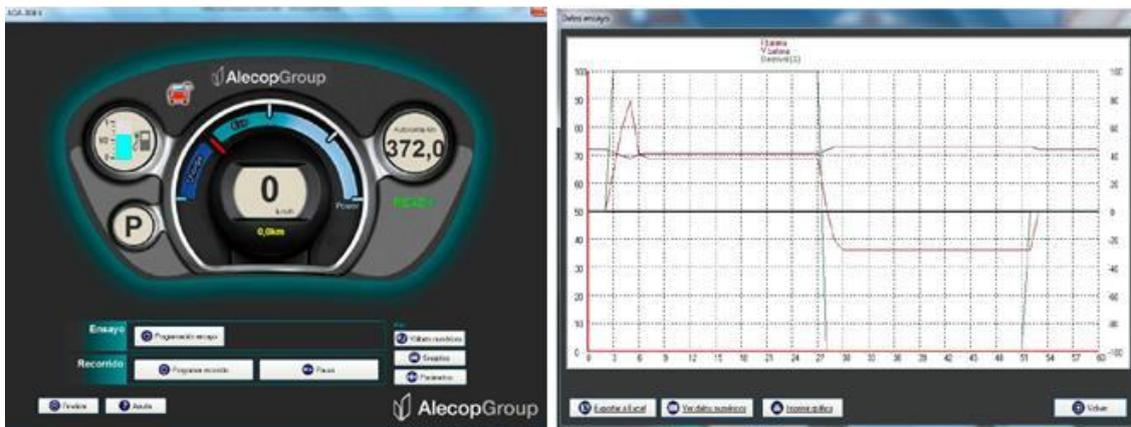
Il pannello interattivo consente di simulare la guida (marce, velocità, stato della batteria, livello del carburante, ecc.) e il software mostra tutte le azioni sullo strumento e/o sulle schermate di misurazione.
