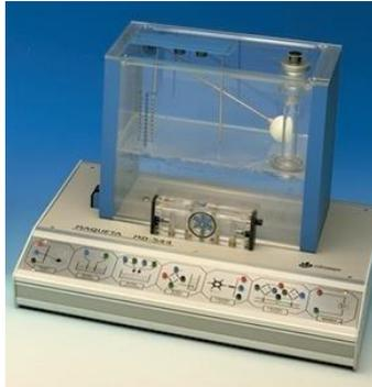
Il modello ha un serbatoio a tenuta stagna con due scomparti, uno per il controllo del livello e l'altro per il drenaggio; c'è una pompa motorizzata che trasferisce il liquido da un posto all'altro e un set di sensori:
