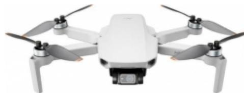
Drone aereo - Gps - Portata ricezione 10000 mt. - Autonomia 31 minuti - Posteriore 12 mpx - Presa usb
